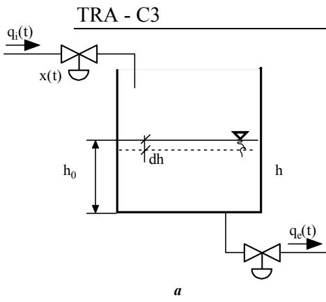
a – Schema tehnologică simplificată a unui rezervor deschis
