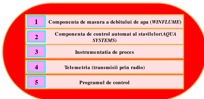
Fig 3. Structura sistemului SCADA corespunzătoare SWD
