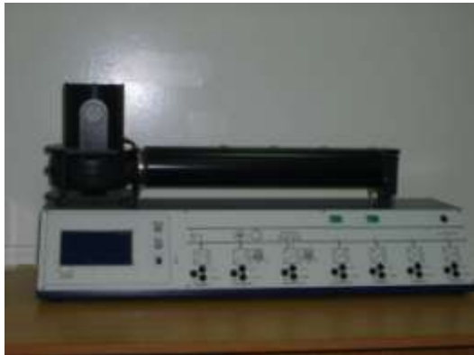
Stand pentru reglarea temperaturii si debitului unui flux de aer recirculat (Elwe LTR701)
